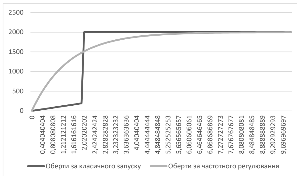
Рис. 4. Динаміка запуску мішалки: класичне керування проти частотного регулювання
